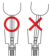
**3** 必ず「カチッ」と音がするまで締めてください。「カチッ」と音がするまで締めないで、外れる恐れや損傷の恐れがございます。
