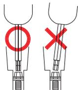
**3** 必ず「カチッ」と音がするまで締めてください。「カチッ」と音がするまで締めないと、外れる恐れや損傷の恐れがございます。
