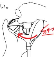
**4** 専用トルクレンチの先が、チューニングウエイトの穴に完全に挿入されていることを確認してください。また専用トルクレンチとクラブヘッドをしっかり支えて交換してください。
