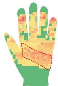
新構造では満遍なく圧力が検知され力が分散されている
