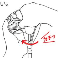
**4** 専用トルクレンチの先が、チューニングウエイトの穴に完全に挿入されていることを確認してください。また専用トルクレンチとクラブヘッドをしっかり支えて交換してください。
